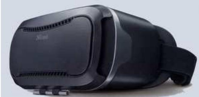
Typische VR-Brille zum Einsetzen eines Smartphones. Nutzbare Displayfläche ca. 135 x 65 mm<sup>2</sup>. Maximalmaße des Smartphones (Rahmen) ca. 150 x 80 mm<sup>2</sup>.
